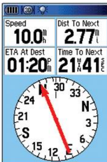
Figura 5. Algunas características que ofrecen los GPS, Velocidad de recorrido, distancia al próximo waypoint, tiempo estimado para llegar al destino, tiempo al próximo waypoint y brújula indicando trayectoria de navegación.
