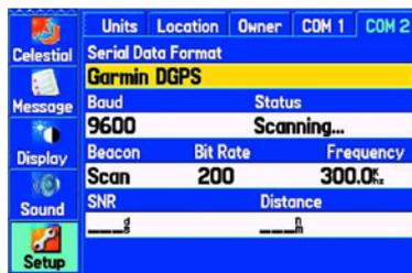
Pestaña 'COM 2' de la pestaña de Configuración con GARMIN DGPS
